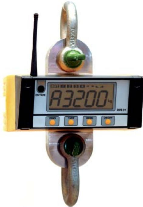
Dinamometro elettronico composto da cella di carico a trazione ed indicatore digitale di peso progettato per la pesatura di carichi sospesi.
